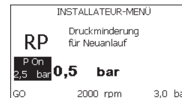
Abbildung 17: Einstellung des Neustartdrucks
